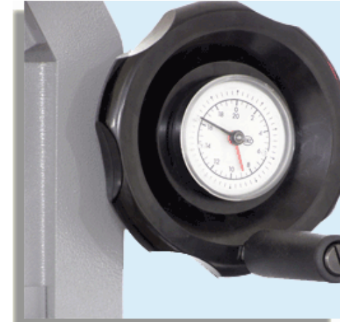
■ Merkezi tutkal merdanesi ile hassas selefon ayarı - 0.01 mm.
